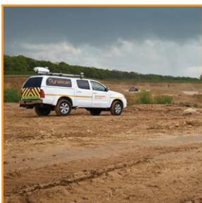
El sistema Dynascan® de Renishaw puede levantar rápidamente extensas áreas, pero para obtener datos de las áreas de sombra necesita un Quarryman Pro.
