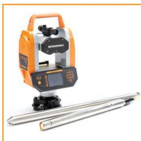
Utilizado conjuntamente con la herramienta de desviación de perforaciones Boretrak, Quarryman Pro permite diseñar tronaduras más productivas.
