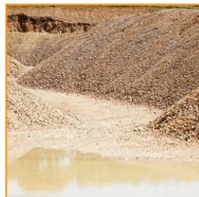
Las tronaduras optimizadas permiten planificar una roca mejor fragmentada para facilitar su retirada.
