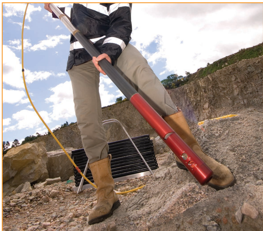
La sonda gira sobre dos ejes para crear completos escaneos de 360 grados de las cavidades.
