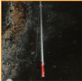
Sistema C-ALS puede ser desplegado para sondear una cavidad subterránea inaccesible.
